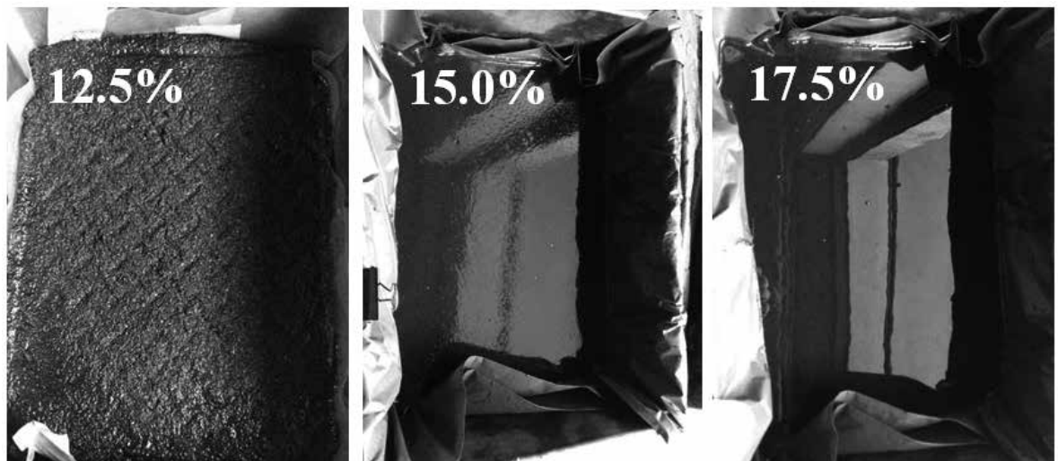
圖3 使用不同樹脂添加量成型之人造建材
