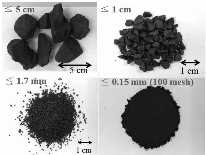
圖1 不同粒度之改質轉爐石作為人造建材之骨材
