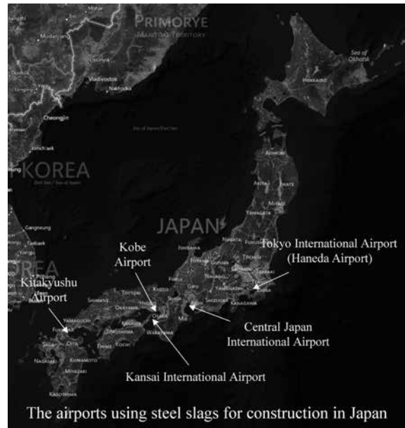
圖 11 日本應用爐石填海造陸作為機場使用地點
