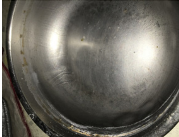
圖3 生鏽的不鏽鋼食品容器
