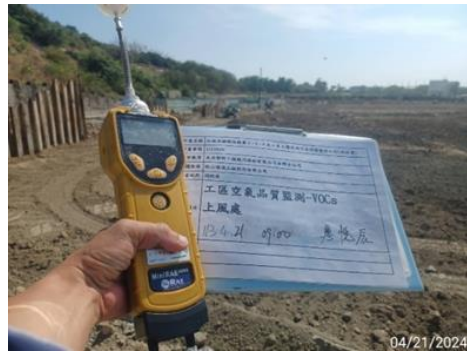
開挖坑下風處手持式PID氣體監測
